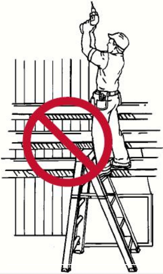
شکل ۱۴ - قطع تماس سه نقطه
