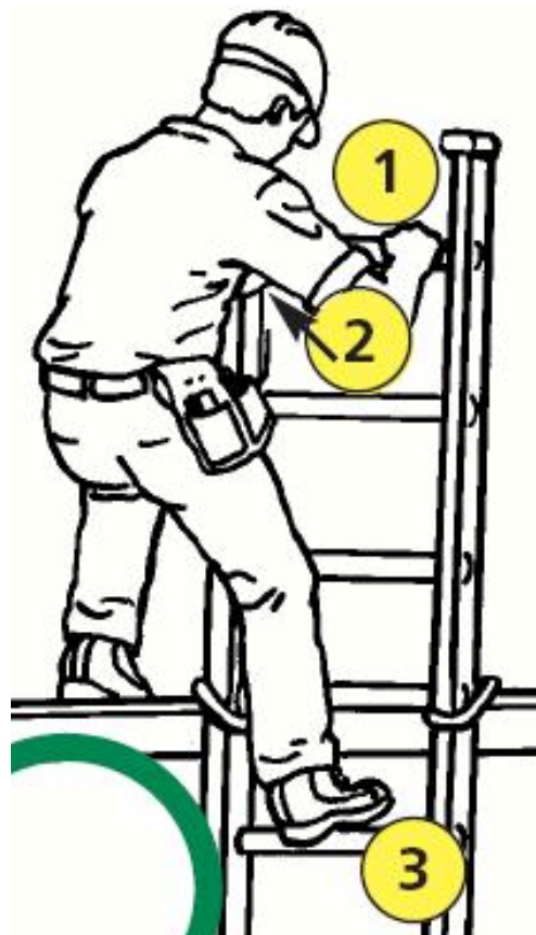
شکل ۱۵ - تماس سه نقطه اتکا
