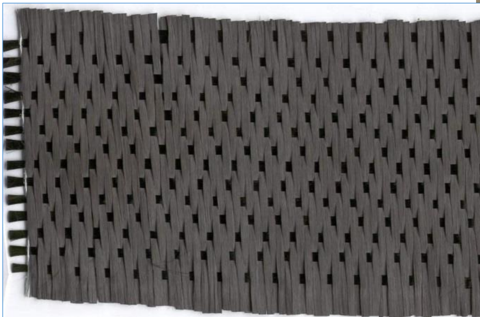
الیاف کربن بافته شده دو جهته 70% تار - 30% پود
